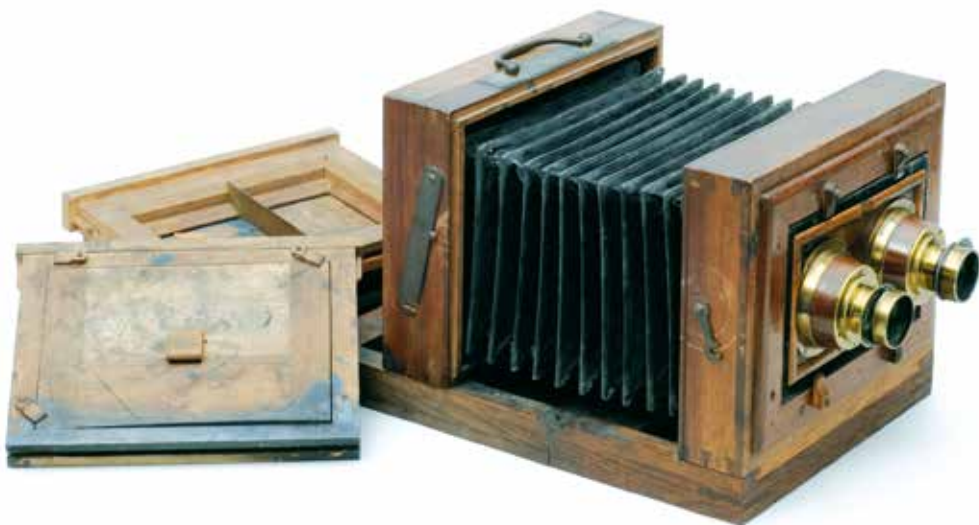
FIG. 3. Cámara de colodión húmedo con sus respaldos portaplacas.
