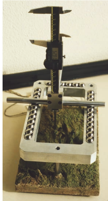
Lám. 162. Sustrato de caliza (loseta) utilizado para recoger el depósito de toba, con el dispositivo para la medida del espesor acumulado. Véase en la lámina 161 A y E losetas instaladas en el río.
