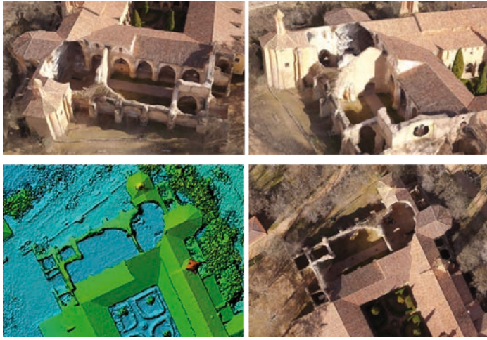
Lám. 107. Productos fotográficos a partir de toma de imágenes con RPAS. Arriba imágenes del modelo 3D Texturado. Abajo a la izquierda, modelo digital de elevaciones. Abajo, a la derecha, ortofotografías. Iglesia abacial de Santa María de Piedra.
