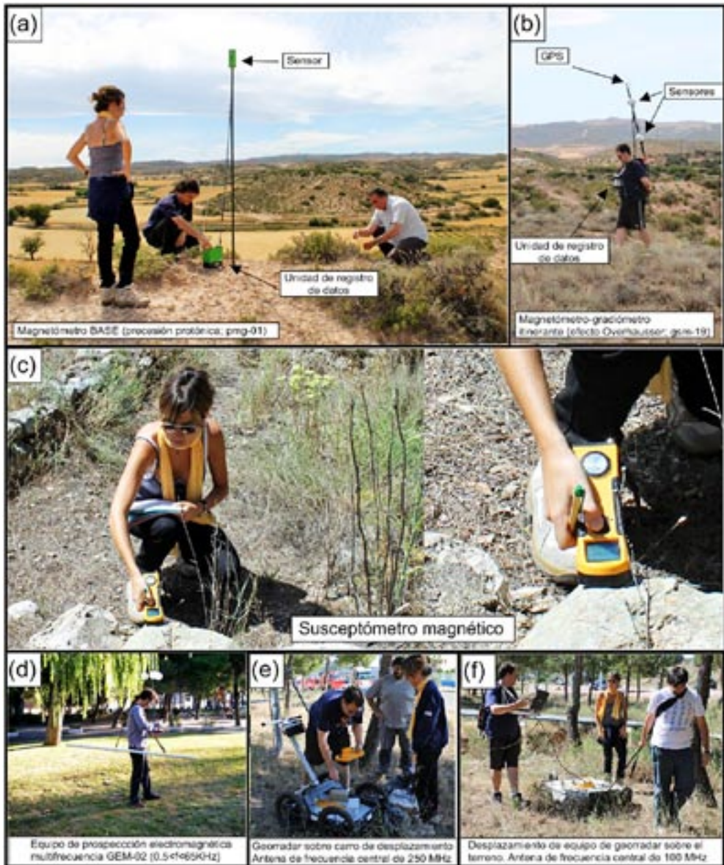
7. Fotografías de los equipos utilizados para la prospección y rutina de muestreo en campo para los distintos equipos de prospección geofísica utilizados. (a) Implantación del equipo magnetómetro base para el control de las variaciones naturales del campo magnético terrestre (equipo PMG-01); (b) prospección areal con magnetómetro en configuración gradiente y GPS (magnetómetro de efecto Overhauser, GSM-19) (c) medida de susceptibilidad magnética en campo en elementos superficiales para analizar los contrastes de variación de los materiales de la zona de estudio; (d) equipo y prospección electromagnética de frecuencia variable (GEM-02); (e y f) equipos de georradar utilizados en la zona de estudio con antenas de 250 y 500 MHz (e) y 100 MHz (f).
