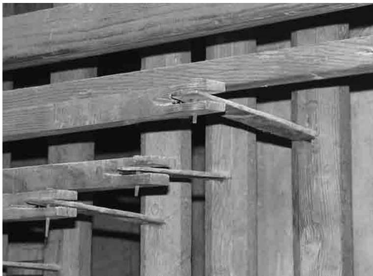
Mecánica de registros antes de la restauración: unión del brazo a la báscula del árbol.
