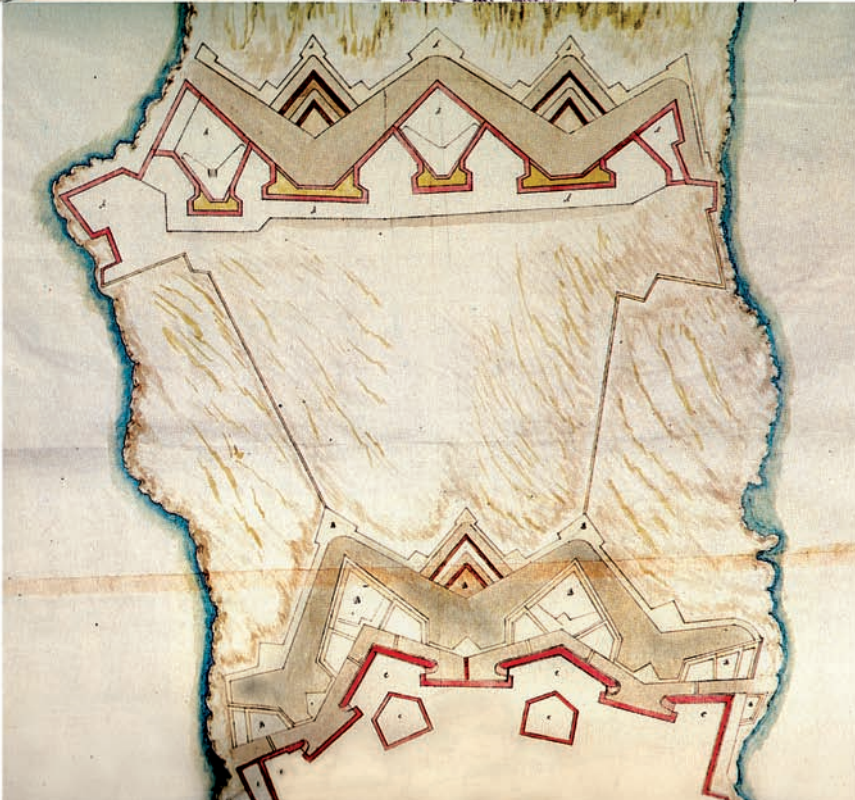
10.13. Descripción de la fortificación de la isla de Malta: 1) Descripción con el parecer para su fortificación de Juan de Médicis en 1639-1640; 2) Detalle de la propuesta de Médicis para el frente viejo de la Valeta y el nuevo frente exterior diseñado por Floriani, véanse los revellines y contraguardias (medias lunas) en el frente viejo diseñadas por Medicis (Francesco NEGRO y Carlo Maria VENTIMIGLIA: Atlante di città e fortezze del regno di Sicilia, 1640, Biblioteca Nacional de Madrid); 3) La fortificación del frente de la Valeta, construida según el proyecto de Médicis (S. SPITERI, 2001).
