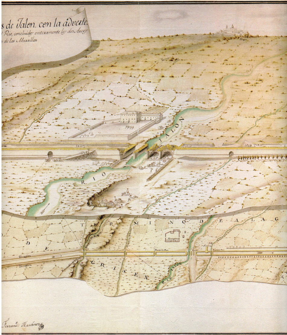
9.7. Canal Imperial de Aragón: «Plan en vista de las obras del Jalón, con la Advertencia de averse executado ya la mudada de el Río, concluido enteramente los dos Arcos de el Puente y aumentado de muchos pies el alto de las Murallas» (detalle), dibujado por Gregorio Sevilla, con el visto bueno de Luis Chimioni y Fernando Martínez, 1779. (Fondo de Planos de Obras Hidráulicas, Ministerio de Fomento; Fuente: Canal Imperial de Aragón, Servicio de Publicaciones del MOPU, 2 tomos, Madrid, 1984, t. II.) Se muestra el estado de la construcción del acueducto a principios de 1779, probablemente marzo. De izquierda a derecha y de arriba abajo se ven, en perspectiva aérea, un puente para el paso de carros, castillete para acarreo de buro o arcilla, un gran almacén de materiales, dos arcos del acueducto en construcción de los cuatro previstos, el pilotaje con madera para encauzar el río, y el paraje ribereño de extracción de la arcilla. En la parte inferior, sin correspondencia y a escala diferente, el mismo paisaje en proyección vertical con algunas de las acequias del río Jalón.
