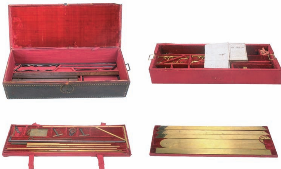
1.5. José de Zaragoza diseñó una serie de instrumentos matemáticos, por encargo del duque de Medinaceli, para el rey Carlos II. Se conservan en una caja que contiene: regla, pantómetra militar, compás armónico (para fabricar el tetracordo, afinar los órganos y templar las guitarras), triángulos (equilátero, filar y pequeño, de usos astronómico y topográfico), cruz geométrica, rombo gráfico (pantógrafo), compás de varilla, cadena de agrimensor, escuadra, tabla de equivalencias y mesa de soporte (Museo Nacional de Ciencia y Tecnología, Madrid).
