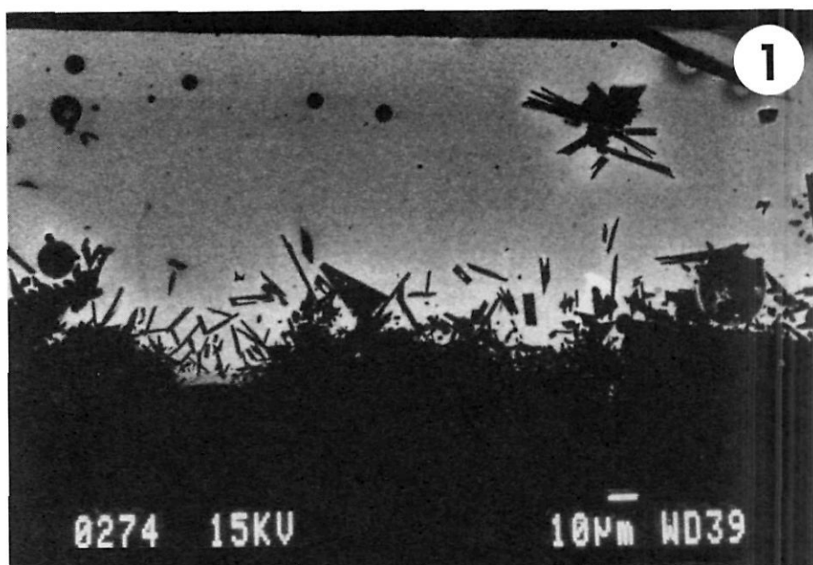
Fig. 1. Imagen de microscopio electrónico de barrido de una sección pulida de un barniz con una interfase gruesa, propia de monococción, con abundantes cristales de feldespato de Pb-K.
