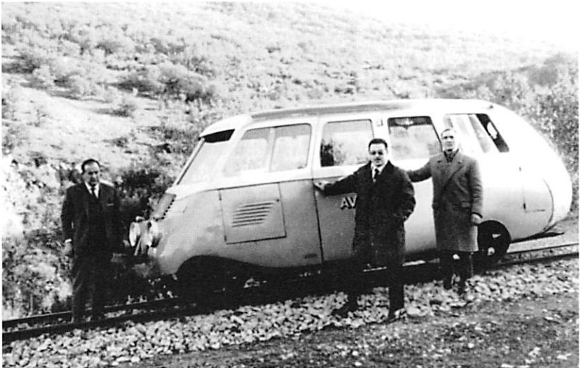
Autovía número 1 utilizado en el ferrocarril para la inspección de la línea y otros servicios especiales.
