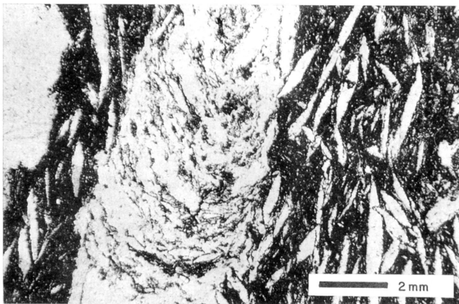
Foto nº 6. Microfotografía de yeso microlenticular primario con bioturbación (muestra ABH-3). El yeso presenta una cantidad importante de matriz carbonatada (micrita). En la mitad izquierda se distingue una traza de bioturbación («burrow») de carácter yesífero más puro con disposición en arcos concéntricos de sus cristales.
