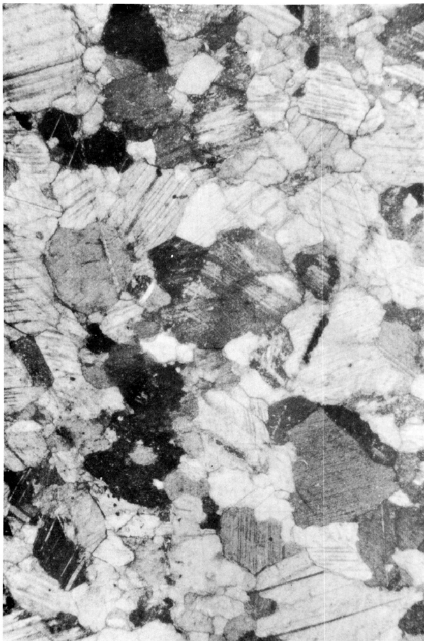
FIG. 5 Mármol del sarcófago de Tarazona (x25, NC.) (Fotogr. DEPARTAMENTO PETROLOGIA)
