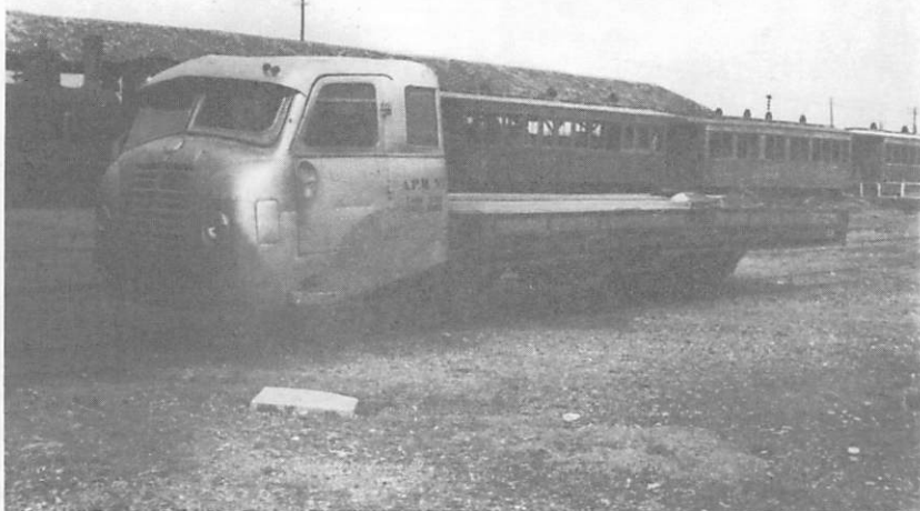
Autovía mercancías APM, número 1, transformación de un autovía de viajeros del Cortes-Borja, 24-6-67.—Foto Ibáñez.
